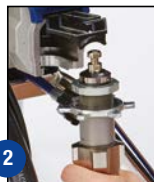
2 Åpne pumpe-dekselet og fjern pumpen
